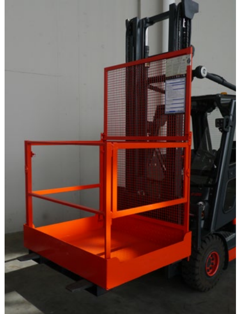
Abb. 3 Arbeitsbühne am Gabelstapler
