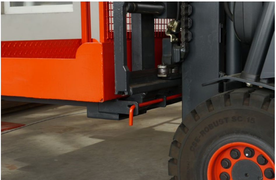
Abb. 2 Formschlüssige Befestigung der Arbeitsbühne
