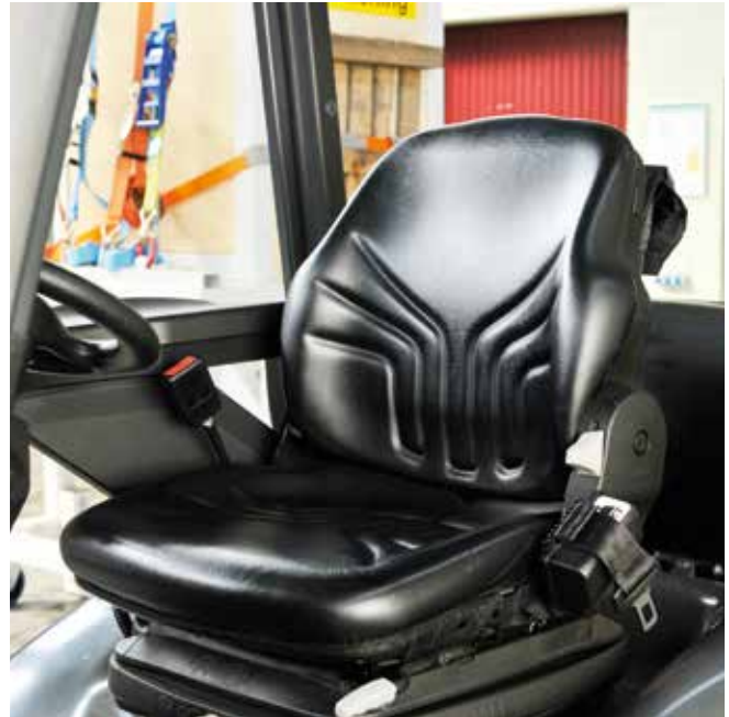
Bild 2-6: Schalensitz mit Beckengurt
