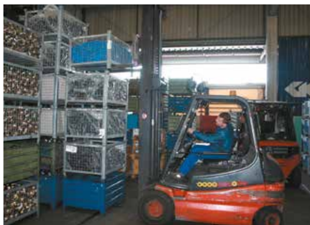
Bild 6-15: Nur zum Auf- und Absetzen mit hoch gestellter Last verfahren
