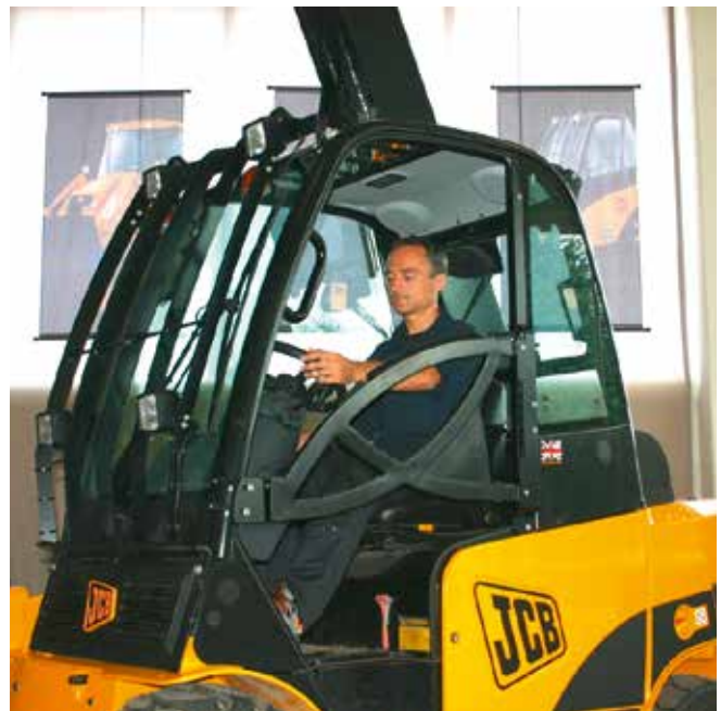
Bild 2-7: Bügeltüren als Rückhalteeinrichtung.
