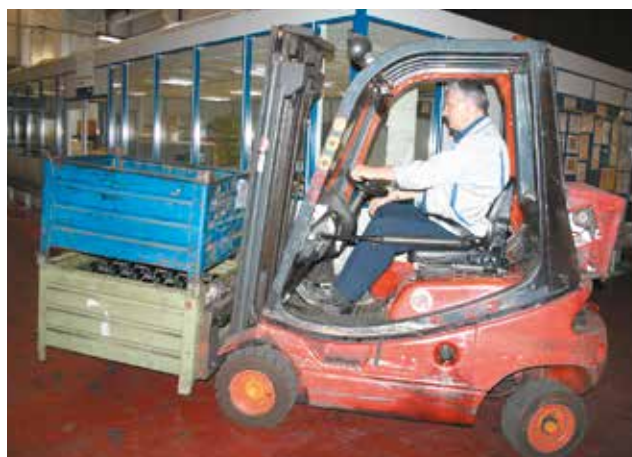
Bild 6-14: Nach hinten geneigter Hubmast
