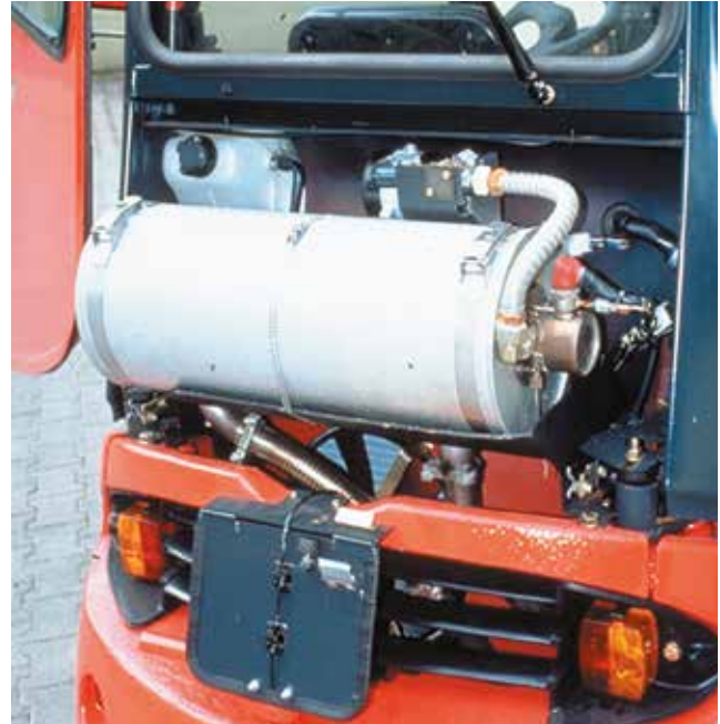
Bild 3-1: Gabelstapler mit Rußfilter und integrierter Regenerations-einrichtung
