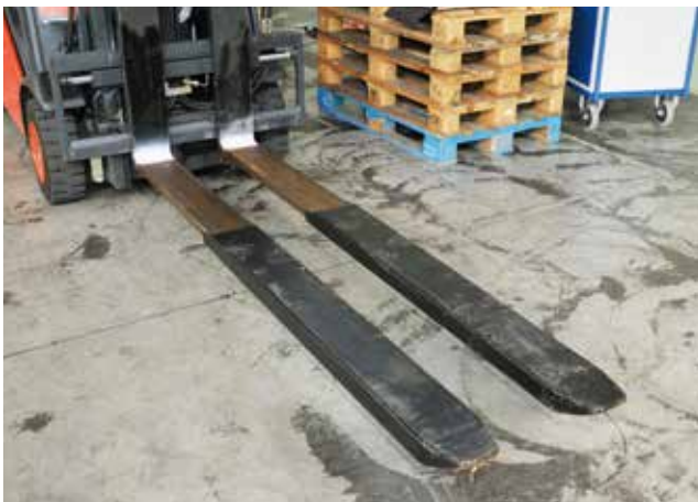
Bild 8-6: Gabelstapler mit Teleskopgabeln
