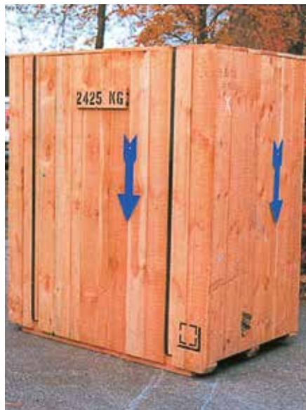
Bild 6-13: ... wo die Gabelzinken einfahren müssen, wie schwer die Last ist und wo der Schwerpunkt liegt, nämlich in der Pfeilspitze.
