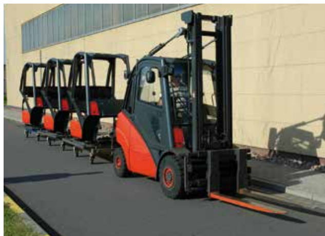
Bild 8-4: Gabelstapler mit Anhängern
