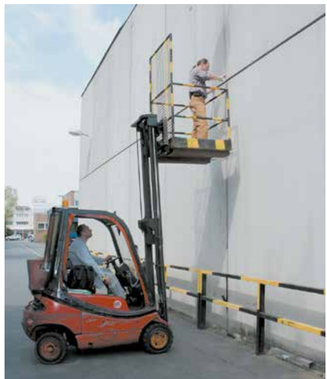
Bild 8-2: Gabelstapler mit Arbeitsbühne
