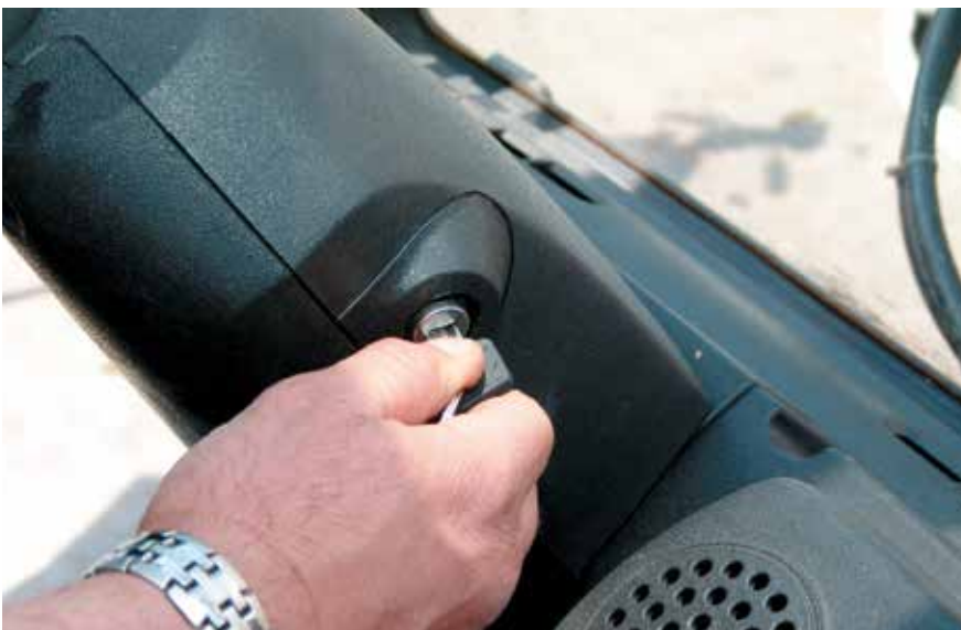
Bild 7-1: Gabelstapler erst verlassen, wenn Antrieb stillgesetzt und Schlüssel abgezogen ist
