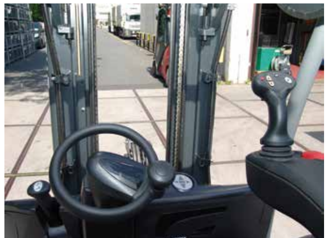
Bild 2-5: Optimal angeordnete Stellteile und bessere Sicht durch ein Freisichthubgerüst gewährleisten ein ermüdungsfreies Arbeiten
