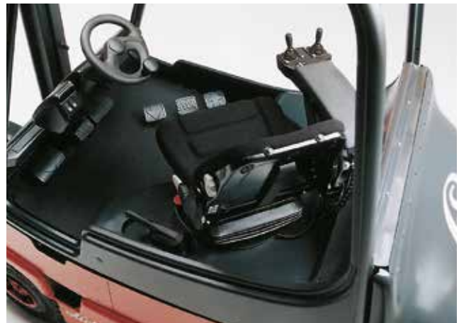
Bild 6-18: Drehbarer Fahrersitz – System „Linde“
