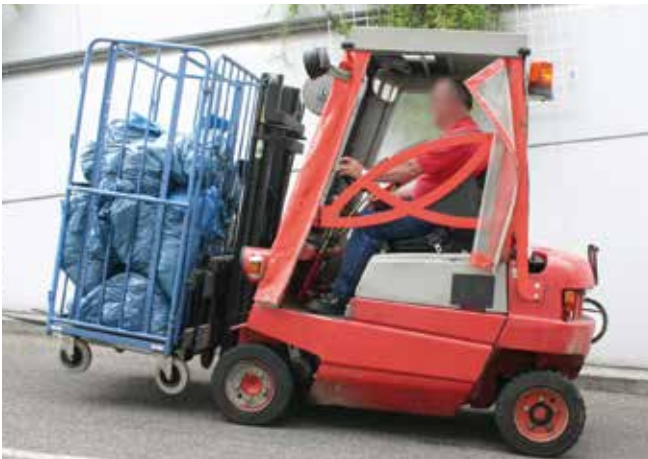
Bild 6-23: Last immer bergseitig führen
