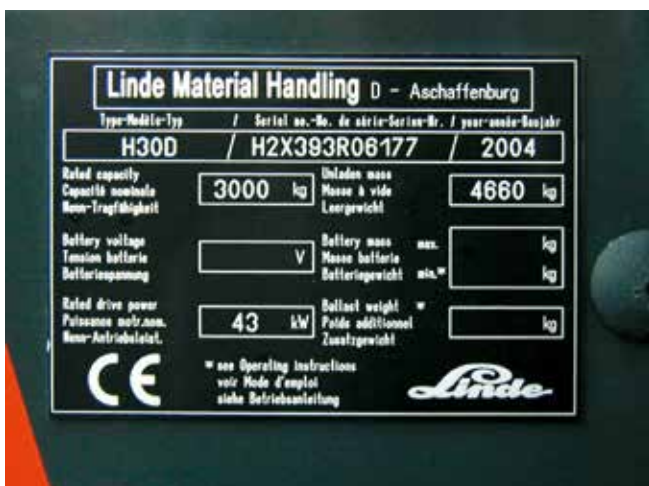
Bild 2-1: Fabrikschild mit CE-Zeichen für ein Flurförderzeug
