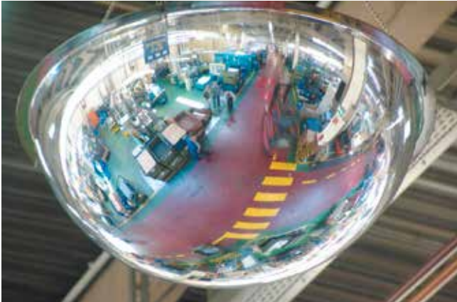
Bild 6-3: Kugelspiegel an unübersichtlicher Stelle
