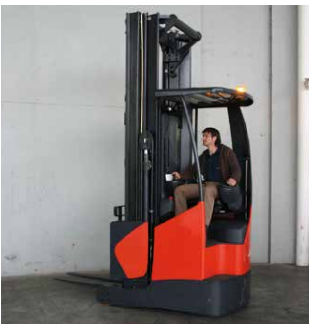
Bild 6-16: Für regelmäßiges Rückwärtsfahren geeigneter Quersitzstapler
