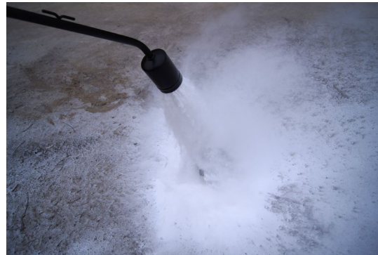
Abb. 47 Die Löschwirkung von Metallbrandpulver beruht auf dem Erstickungsprinzip
