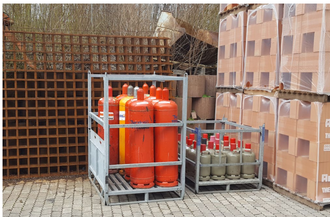
Abb. 27 Lagerung von Gasen incl. Transportgerät
