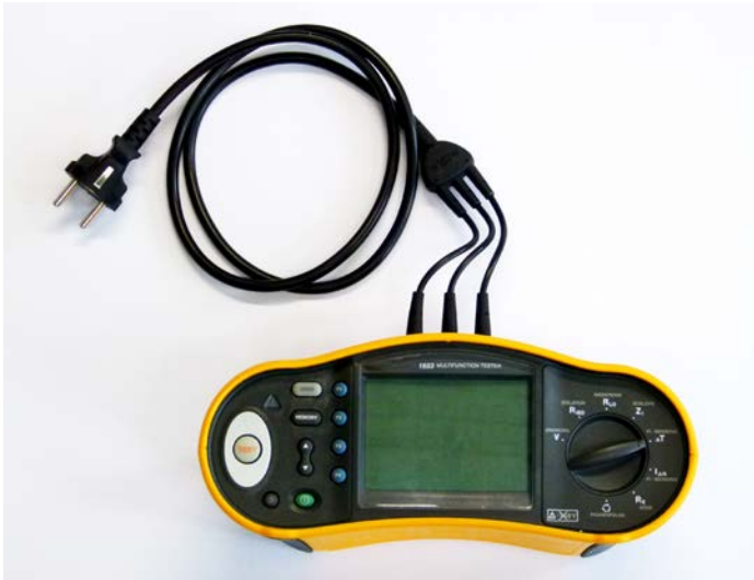
Abb. 29 Prüfgerät für Messungen an elektrischen Anlagen und Betriebsmitteln
