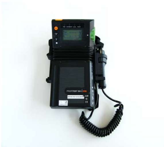
Abb. 38 Prüfgerät für Messungen an elektrischen Anlagen und Betriebsmitteln
