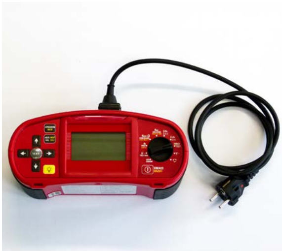
Abb. 34 Prüfgerät für Messungen an elektrischen Anlagen und Betriebsmitteln, Prüfung von RCD Typ B
