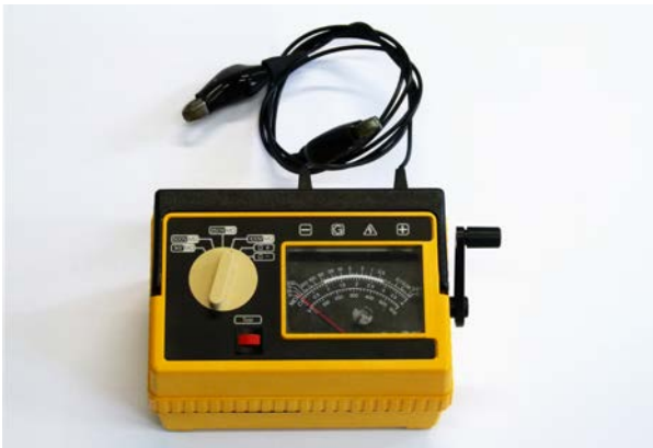
Abb. 28 Prüfgerät zur Ermittlung des Schutzleiter- und Isolationswiderstandes mit Analoganzeige. Prüfspannung wird über Drehkurbel erzeugt.
