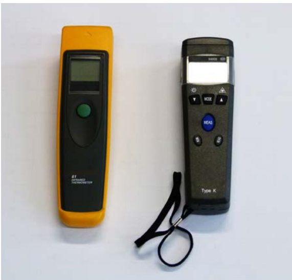
Abb. 48 IR-Thermometer für berührungslose Temperaturmessungen
