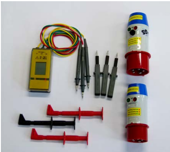
Abb. 42 Drehfeldprüfgerät, Prüfspitzen und Prüfadapter für Drehstrom- Anschlüsse
