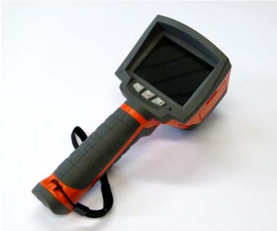
Abb. 47 Thermographiekamera für die schnelle und zielgerichtete Detektion von Wärmequellen
