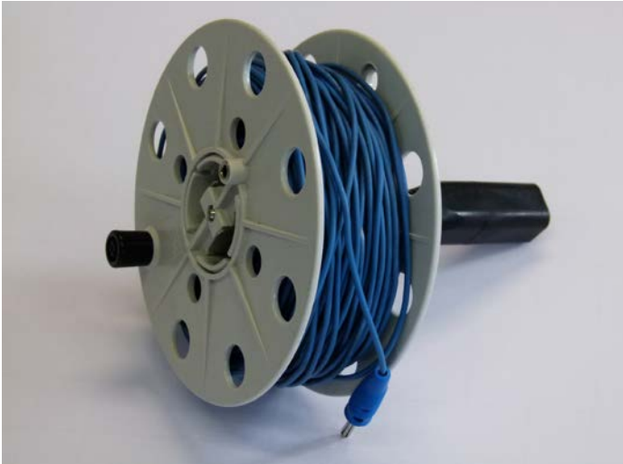
Abb. 45 Lange Messleitung auf Spindel für Schutzleiterwider- standsmessungen
