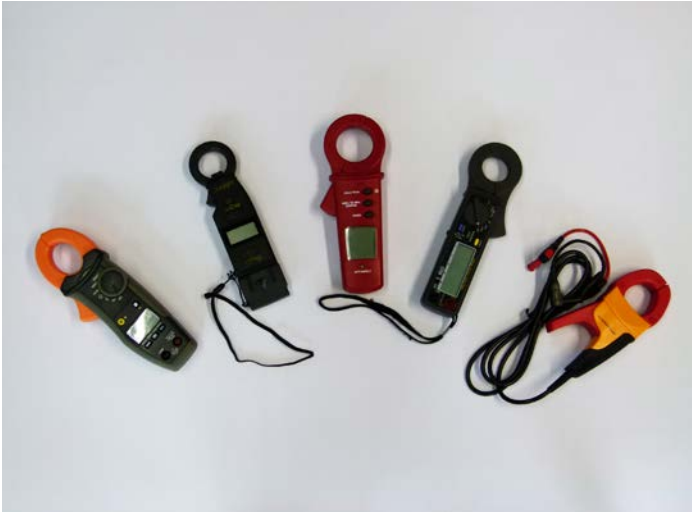
Abb. 39 Strommesszangen („Zangenampere-meter“); Einzelgeräte und Adapter
