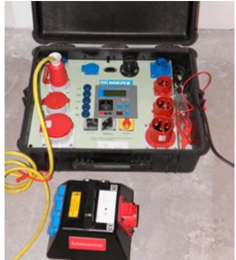
Abb. 5.7 Mobiles Prüfgerät für Verlängerungen und elektrische Betriebsmittel mit automatischen Gerätetestern zur Prüfung nach VDE 0701-0702
