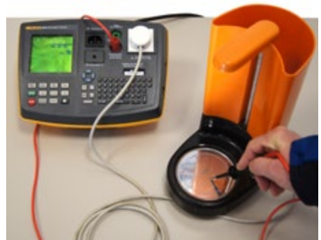
Abb. 5.5 Prüfgerät mit Tastatur, über die eine große Anzahl nummernkodierter Prüfsequenzen angewählt werden können. Zusätzlich besteht eine Anschlussmöglichkeit für die Prüfung von Kaltgeräteleitungen
