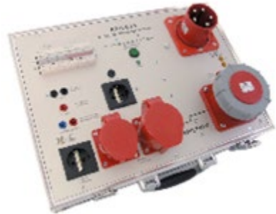
Abb. 7.8 Prüfgerät (vorgesehen für das Prüfen von Schweißstromquellen nach VDE 0544-4). Die Ablaufsteuerung der Prüfschritte, die Messwertaufnahme und die Dokumentation erfolgt durch PC oder Notebook.
