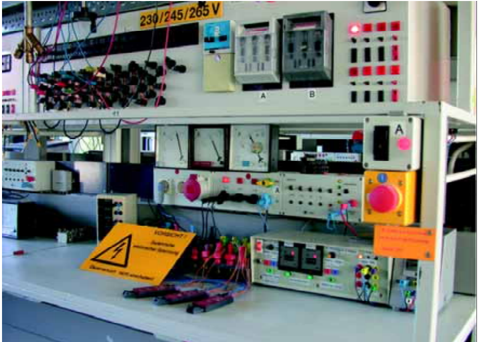
Bild 10: Dauerversuch in abgeschlossenem Raum, das Prüffregal liegt seitlich zum Hauptverkehrsweg. Berührungsschutz ist ausreichend, zufälliges oder unbeabsichtigtes Berühren ist durch Anordnung und Wahl der Anschlussmittel verhindert.
