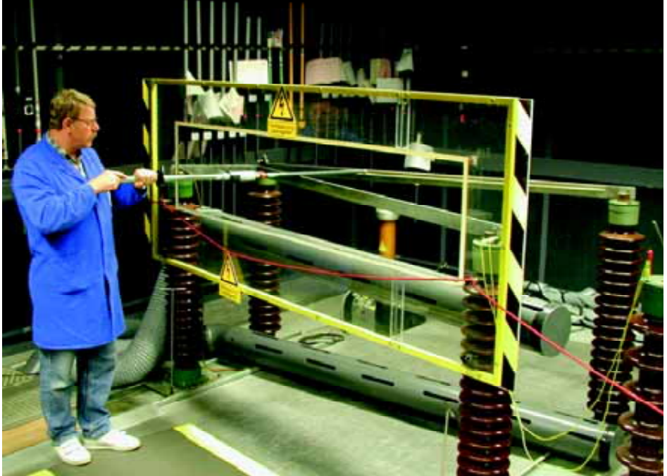
Bild 8: Prüffeld, Wiederholungsprüfung an einem Spannungsprüfer, Abrolltest. Abgrenzung durch Seil und Polykarbonatscheibe, Absaugung (Ozon!)
