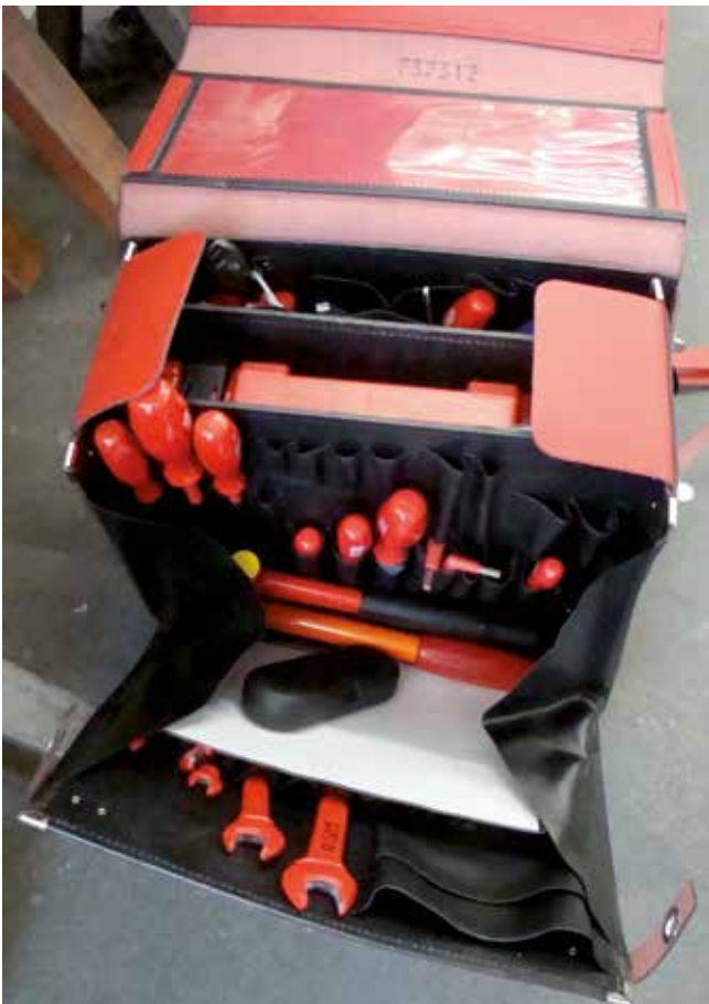
Bild 5-24: Besondere Werkzeugtasche mit isoliertem Werkzeug für Arbeiten an unter Spannung stehenden Teilen im Niederspannungsbereich
