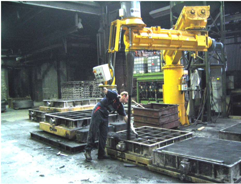
Abbildung 1: Handformen, Formsandzufuhr aus Mischer (Quelle: Regierungspräsidium Kassel)
