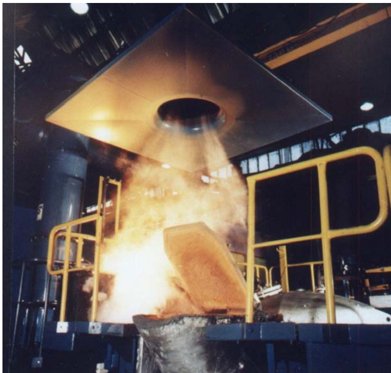
Abbildung 5: Werksfoto Kessler+Luch – Düsenplatte an einem Schmelzofen
