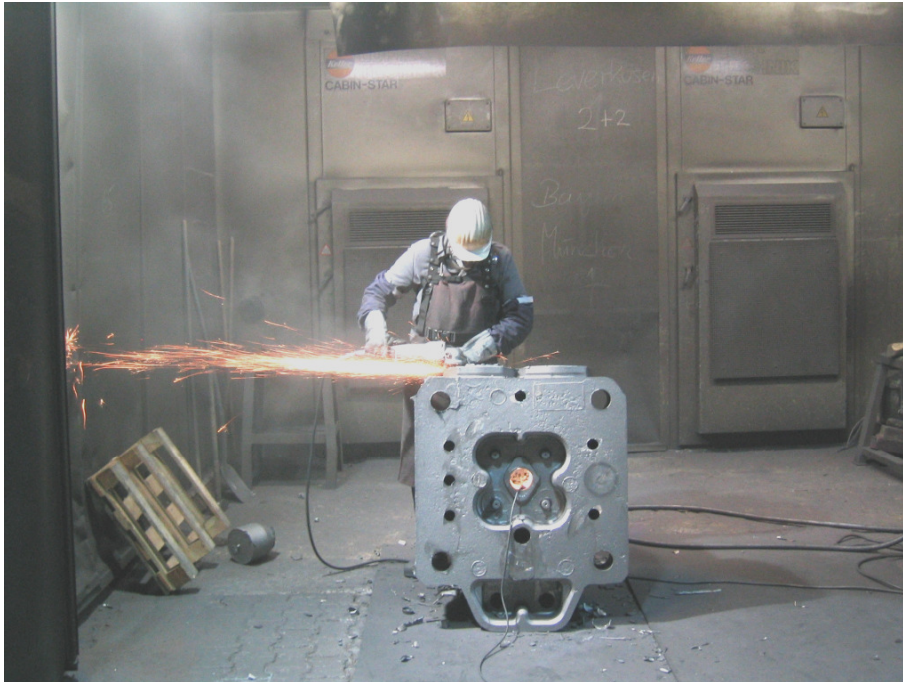
Abbildung 3: Putzarbeiten in einer Arbeitskabinen (Quelle: Regierungspräsidium Kassel)
