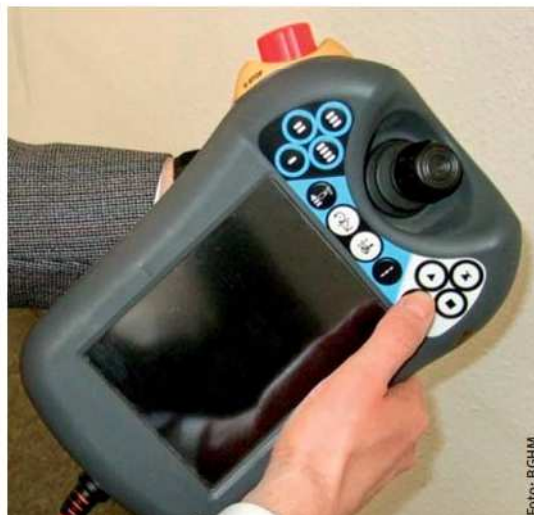
Handbediengerät in korrekter Ausführung mit rot-gelbem Not-Halt
