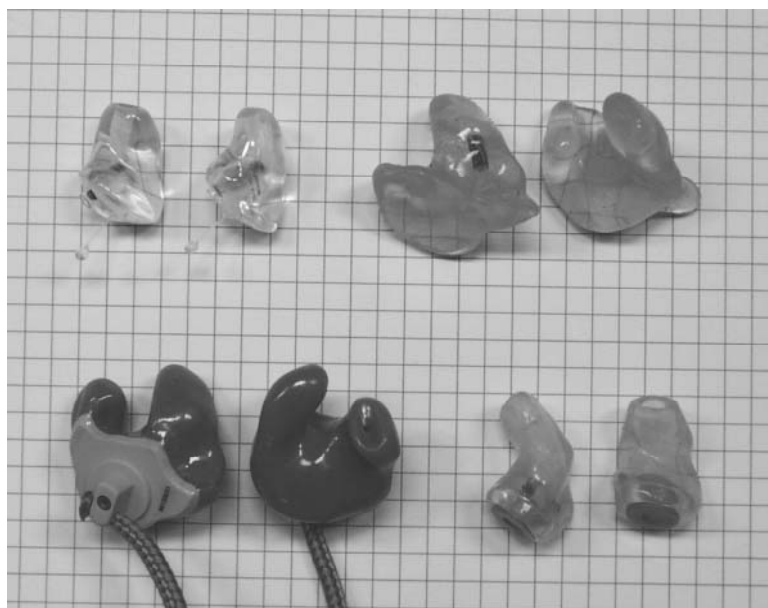
Abbildung 10: Gehörschutz-Otoplastiken für die Grobbestimmung der Minderung der Schalldämmung
