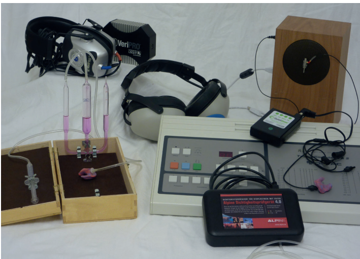
Abbildung 11: Beispiele für Geräte zur Funktionskontrolle (Überdruck- und akustische Verfahren)
