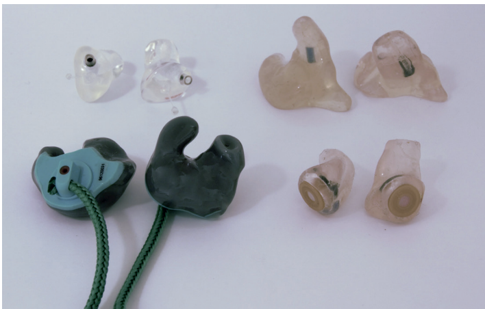
Abbildung 18: Gehörschutz-Otoplastiken zur Bestimmung des Dämmverlusts durch gezielt falsches Einsetzen der Otoplastik
