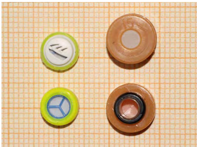
Abbildung 3: Beispiele von Membranfiltern: Links: DM-Filter von Dynamic Ear Company Rechts: ER-15-Filter von Etymotic Research Oben: von außen sichtbarer Teil des Filters Unten: zum Gehörgang zeigender Teil
