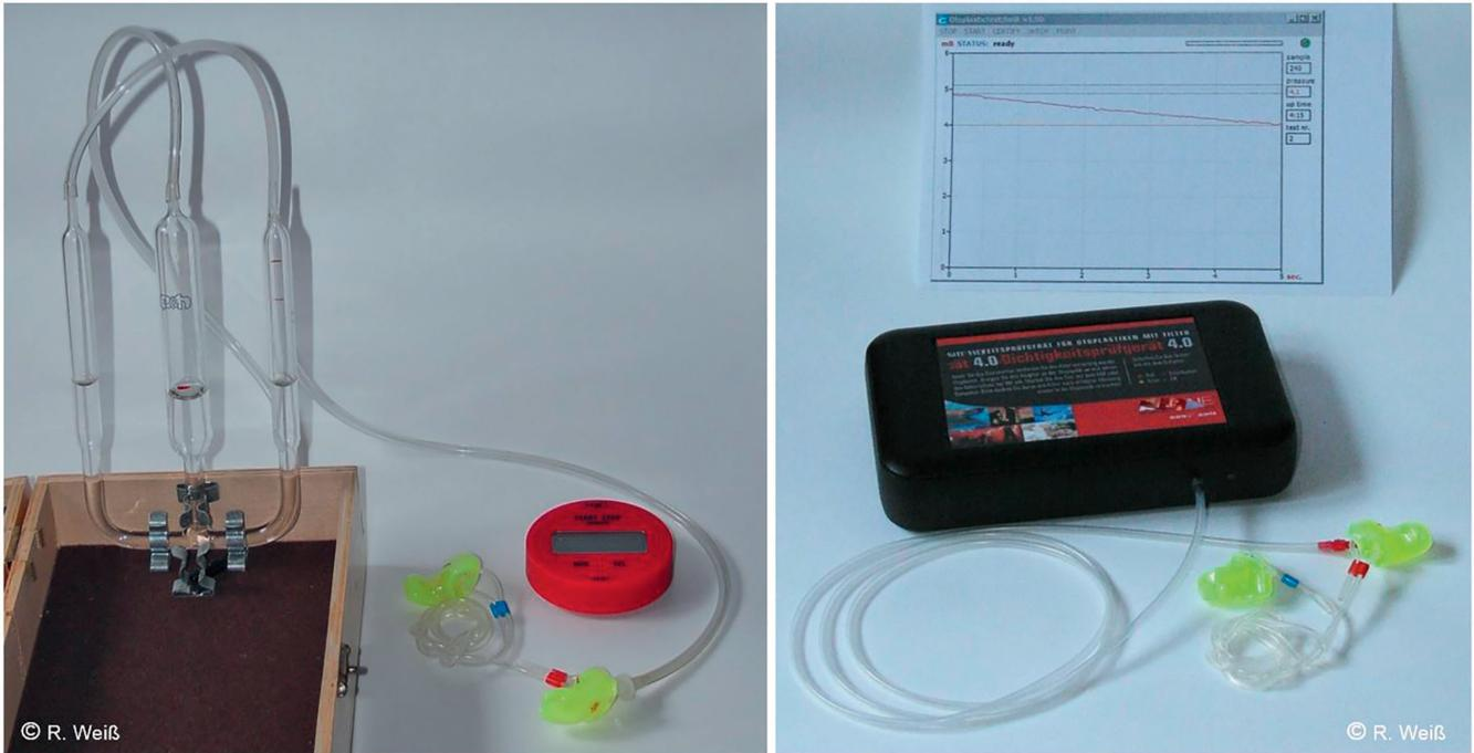
**Abbildung 9:**Überdruckverfahren; links: flüssigkeitsgefülltes W-Rohr-Manometer; rechts: Dichtigkeitsprüfgerät (automatisierte Druckprüfung)
