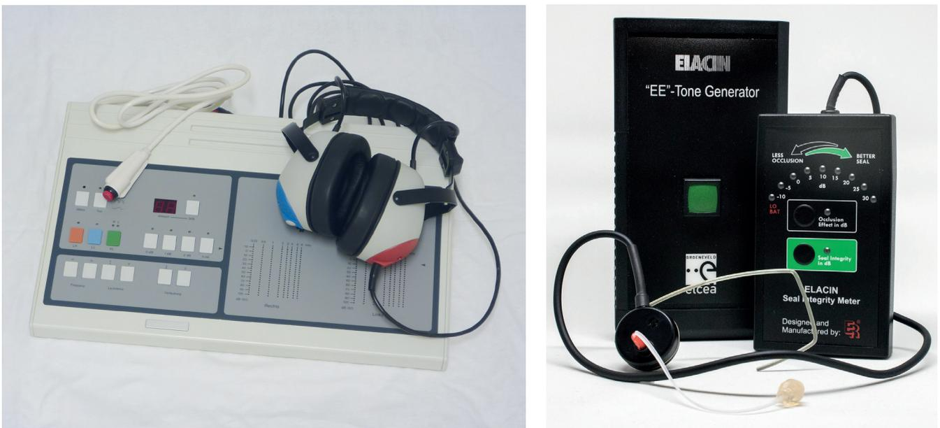
**Abbildung 10:**akustische Messverfahren, links: Audiometrie (subjektiv), rechts: SI-Meter (Ear-Seal, objektiv).
