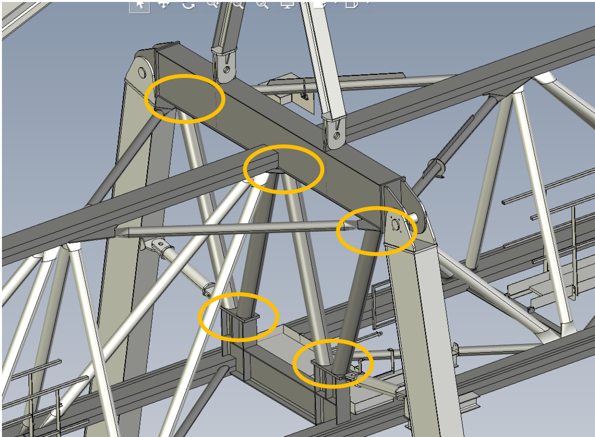
Abbildung 4 Aufhängung von Fachwerkträgern an Stützen
