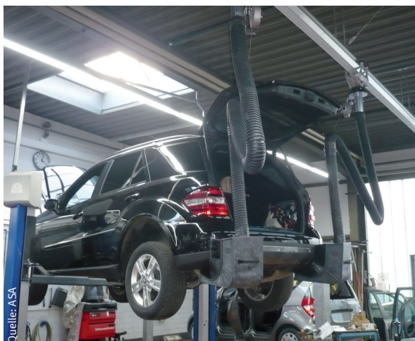
Bild links: Saugschlitzkanal mit 2 Saugereinheiten für 2-flutige Auspuffanlagen
