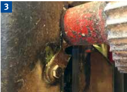
3 Sicherung der oberen Druckwalze gegen Absinken durch eingeschwenkte mechanische Sperre
