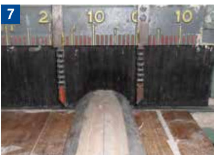
7 Eine leichtgängige Rückschlagsicherung umschließt das Werkstück lückenlos und verhindert das Heraus-schleudern von Splintern.
