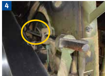
4 Formschlüssige Sicherung gegen Herabsinken des Sägerahmens
