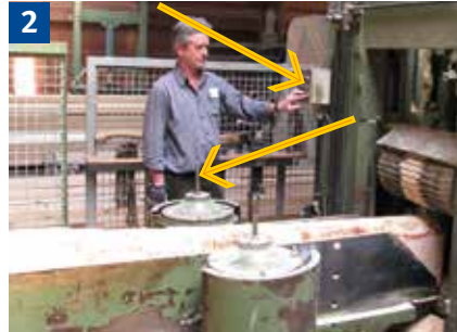
2 Störungsbeseitigung am Spaltkeil, Auszugswalzen mit Griff
