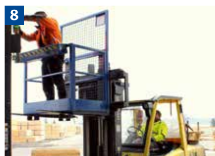
Instandhaltungsarbeiten mit Gabelstapler und Arbeitsbühne
