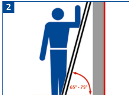
Anlegeleitern im richtigen Winkel (65° – 75°) anlegen.
