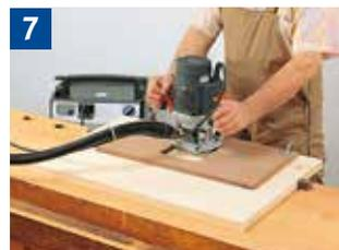
7 Einsatz der Handoberfräsmaschine mit Schablone
