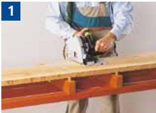
1 Sägen von Massivholz auf Unterlagen mit Anschlagknoppen
