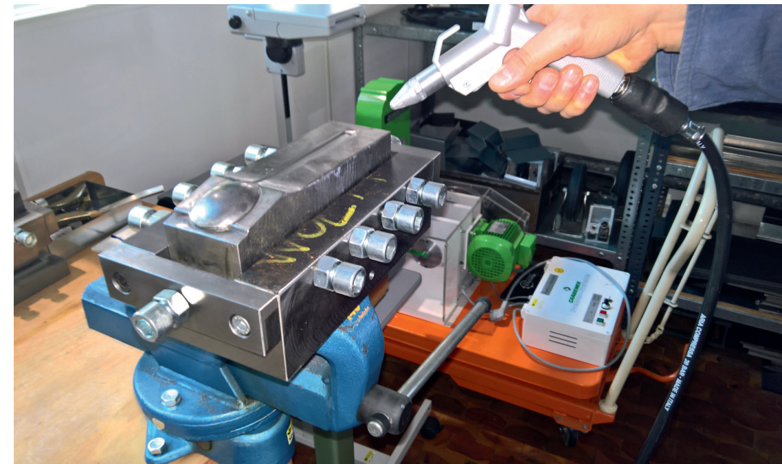
Lärmarme Sicherheitspistole mit aerodynamischer Aluminiumdüse und fünffacher Blaskraft gegenüber einer konventionellen Blaspistole
