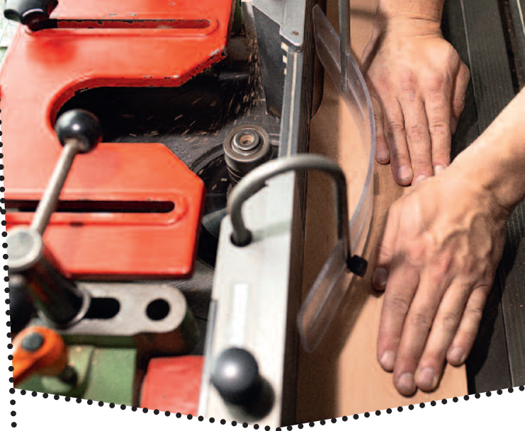
Die richtige Handhaltung beim Führen des Werkstücks an der Holzfräse.
