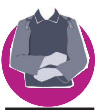
Aber auch die Arme sind nah am zu schweißenden Werkstück. Ärmelschoner bieten einen zusätzlichen Schutz.
